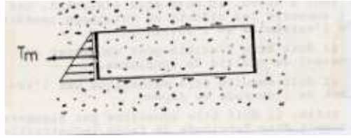
Figure 29 : Hypothèse de calcul pour les bandes de roulement sur chant
