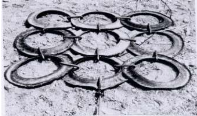
Figure 28 : Flancs en nappe
