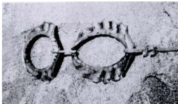
Figure 23 : Allure des flancs après l'essai de traction
